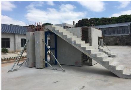
设置装配式建筑样板房，并设有预制梁、板、柱、剪力墙等构件展示区。
